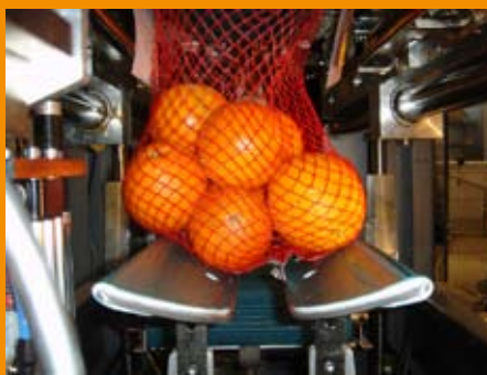
Sistema de llenado con elevador Filling system with elevator
